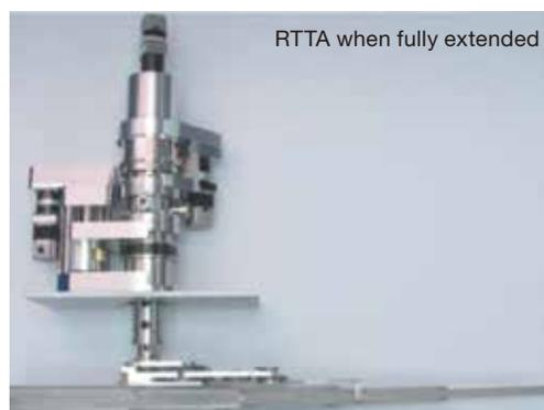
RTTA シリーズは、マルチチャンバーへのサンプル搬送用に開発された搬送機構です。この製品は超高真空下で使用可能で、搬送アームが 3 段に伸縮する機構を採用することで最小のスペースで最大のストロークを稼ぐことを可能にしました。**アーム先端に 1kg の加重をかけ、760mm フルストローク伸ばした場合の先端の垂れは 1mm 以下**と安定した搬送をお約束します。回転・上下・伸縮の各駆動は全て自動化することが可能です。
